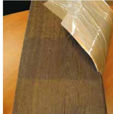
Nach 2 Monaten, Endausführung Nr. 4, UV-Licht ausgesetzte Lamelle = auf der Vorderseite festgestellt sehr deutliches Ausbleichen der dem UV-Licht ausgesetzten Lamelle.
