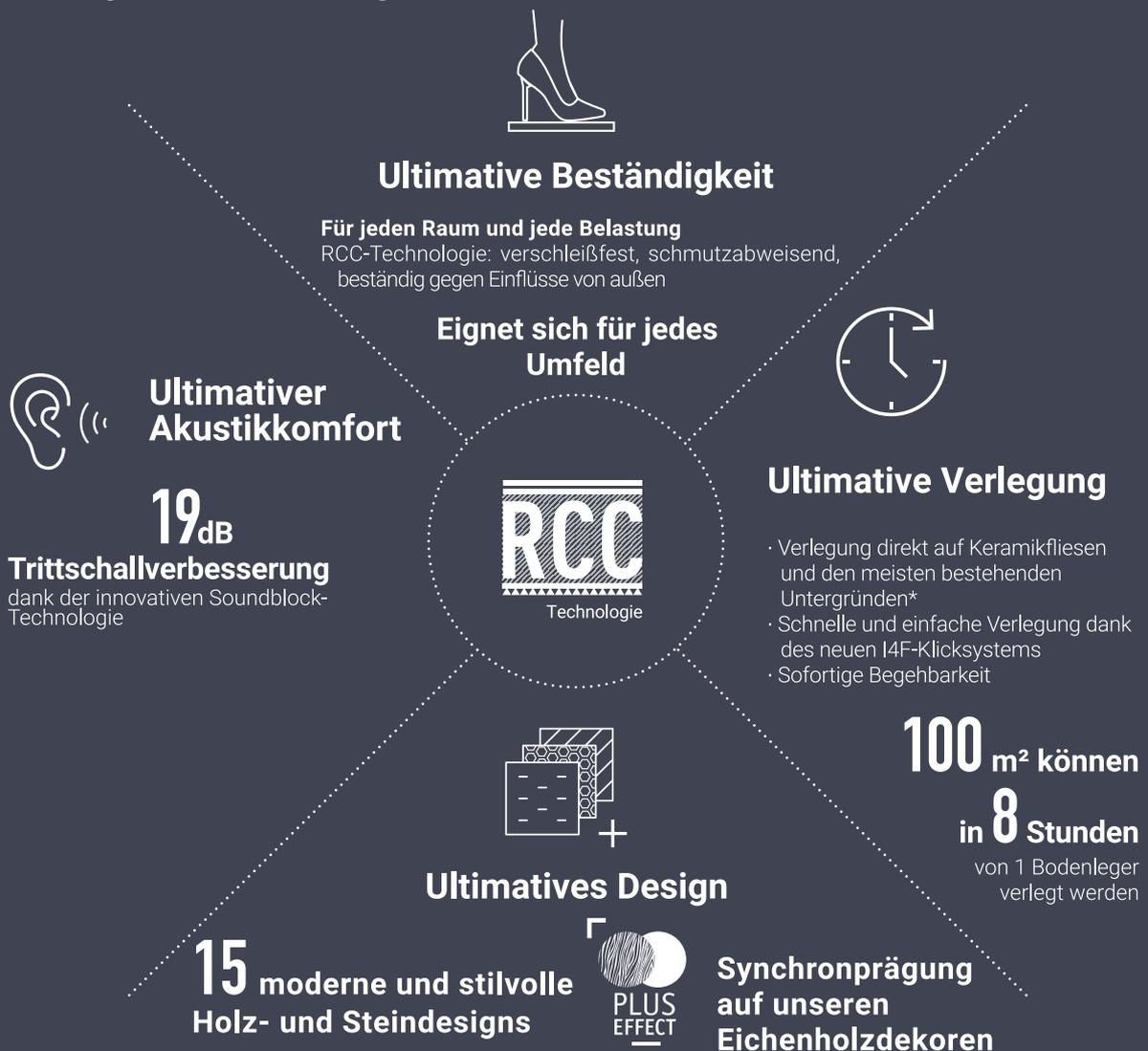
\*Verlegbar auf Keramikböden mit Fugen bis zu 8mm Breite und 3mm Tiefe
