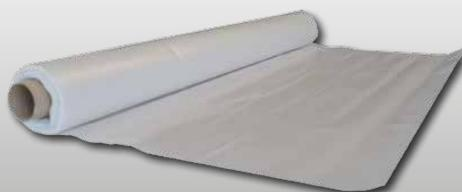
Geeignet als Zwischenlage zwischen Estrich oder Dämmunterlage unter allen Hartbodenbelägen zum besseren Gleitverhalten. Die DIN-Norm 18365 (Bodenbelagsarbeiten) sieht die Verwendung einer feuchtigkeitshemmenden Folie (Dampfbremse) auf allen Estrichen und Spachtelmassen vor. Dies gilt auch bei Altbauten.
