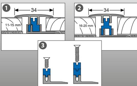
Zur Basisprofilerhöhung für Clipprofil oder Schraubprofil
