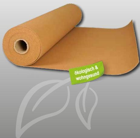
Rollenkork findet meist Verwendung als Dämmunterlage bei der Verlegung von Böden. Diese baubiologisch wertvolle Unterlage aus Korkgranulat schafft eine hohe Behaglichkeit und gleicht kleine Unebenheiten des Untergrundes erstaunlich gut aus. Zudem absorbiert Rollenkork wirksam Trittschallgeräusche und isoliert gegen Kälte und Wärme. Kork unterstützt die Raumluftregulierung und trägt somit zu einem angenehmen und gesunden Wohnklima bei. Rollenkork ( 2 mm / 4 mm) ist für Fußbodenheizung geeignet.
